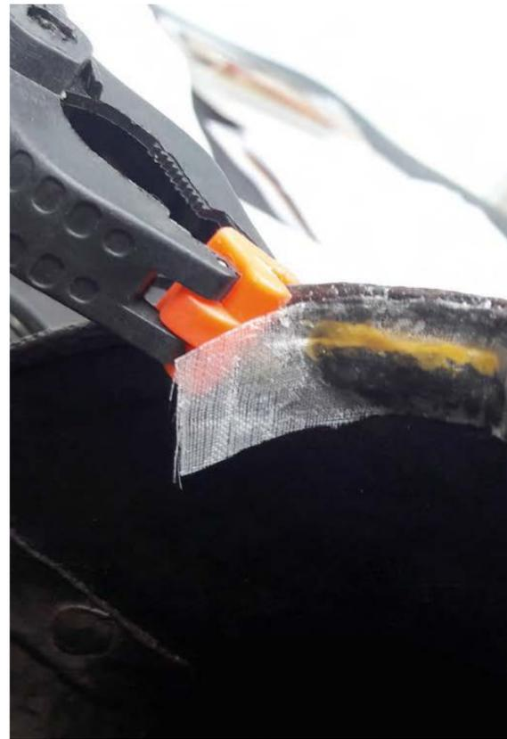
Pose d'un intissé de fibre de verre imprégnée de résines acrylique et époxyde au revers des pièces.
