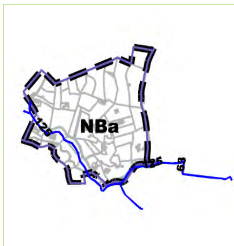
RÉSEAU D'ALIMENTATION EN EAU POTABLE
