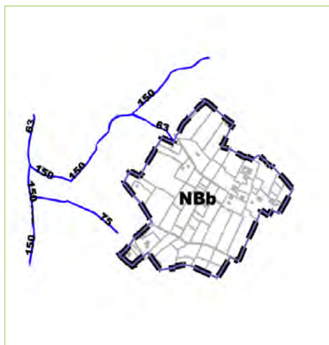
RÉSEAU D'ALIMENTATION EN EAU POTABLE
