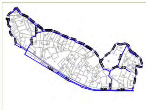
RÉSEAU D'ALIMENTATION EN EAU POTABLE
