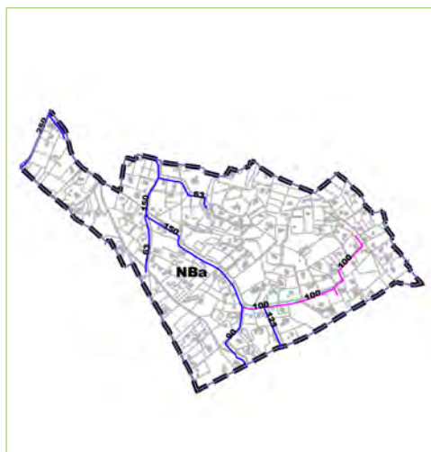
RÉSEAU D'ALIMENTATION EN EAU POTABLE
