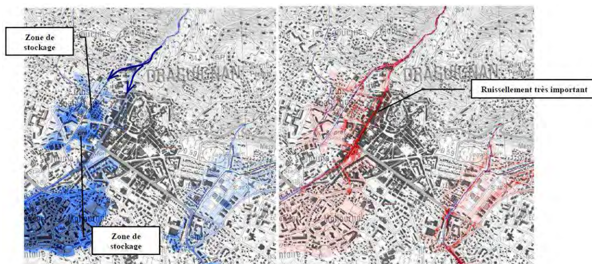
Figure 27 : Hauteur d'eau et vitesses d'écoulement – Vallon de Rialle
